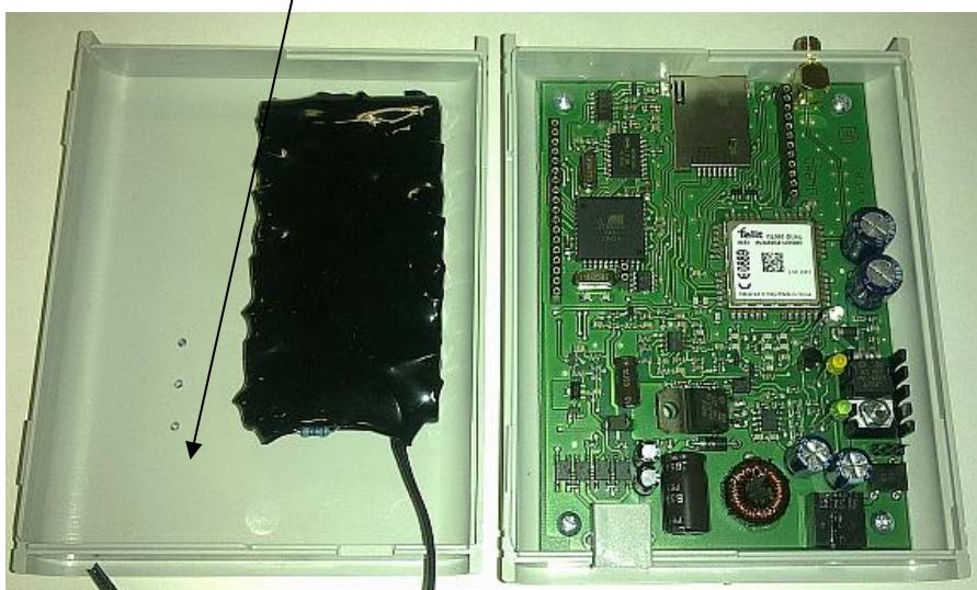
4. Akumulátory nemusí být dodány v nabitém stavu. Zapněte nejdříve bránu, Počkejte, až se zaloguje do GSM sítě. Pak připojte kabel od akupacku do konektoru.
