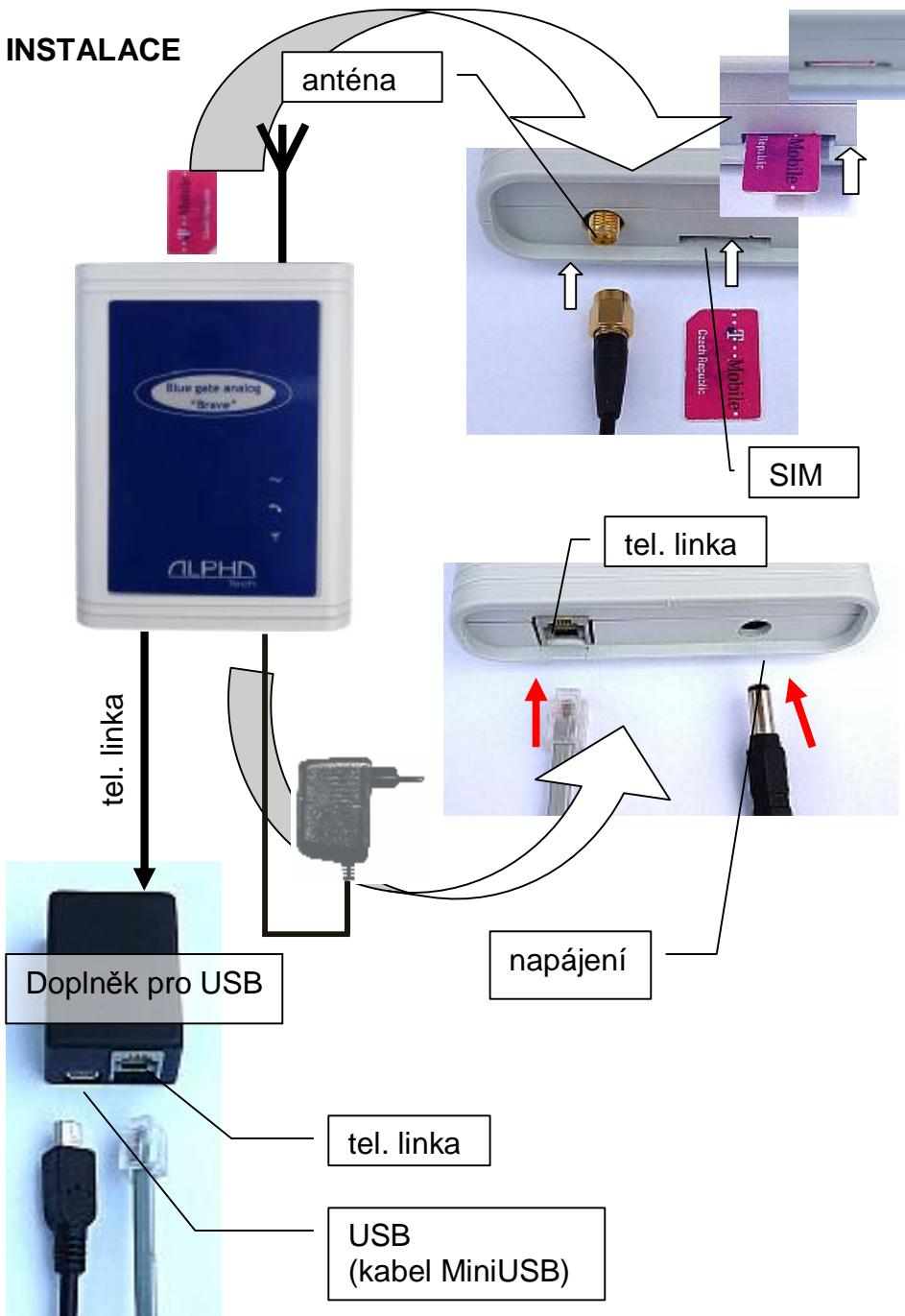
Zasuňte SIM kartu orientovanou podle obrázku a zamáčknutím zajistěte v pracovní poloze. **Doporučujeme před vložením SIM karty si na libovolném GSM telefonu ověřit její stav (zapínání s PIN, či bez PINu, PIN atd.) a nastavit zapínání bez PINu.** Pokud chcete použít zapínání s PIN, musíte tento PIN nastavit při programování brány a nastavit zapínání s PIN (viz. tabulka programování). **Bez tohoto nastavení nebude brána v provozu!**
